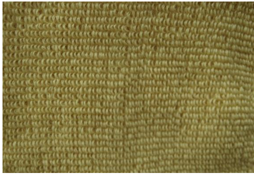
1.3 ábra Az rezgéscsillapítás céljára hurkosított kelme felülete (11. minta)
