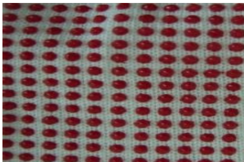
1.5 ábra PVC pöttyökkel módosított kelmefelület
