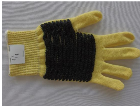
1.4 ábra Az rezgéscsillapítás céljára hurkosított kelmefelület a kesztyű tenyér részén
