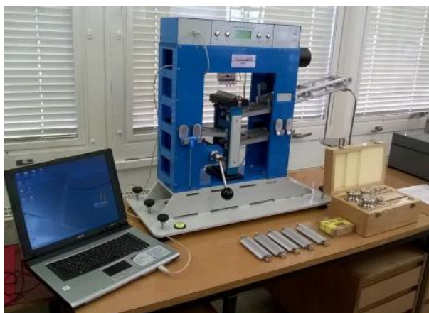
3. ábra. Éles tárgyak okozta vágás mérőműszere az MSZ EN ISO 13997:2000 szabvány szerint (TDM vizsgálat)
